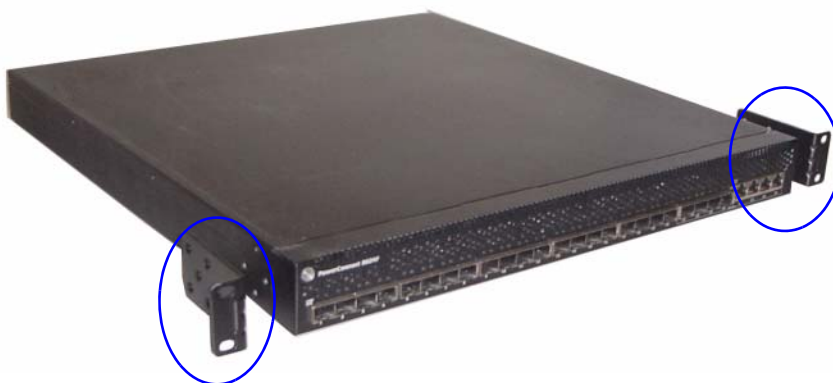
Ilustración 1. Fijación de los soportes
