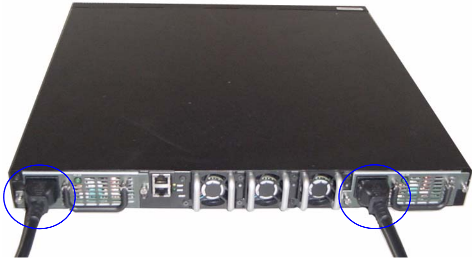
図 2 電源ケーブルの接続
